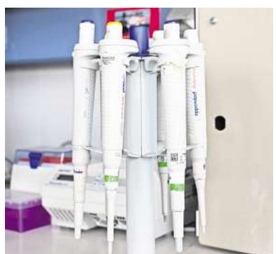
Ein Zehntel Mikroliter kann hiermit dosiert werden. FOTO: GRUNOW
